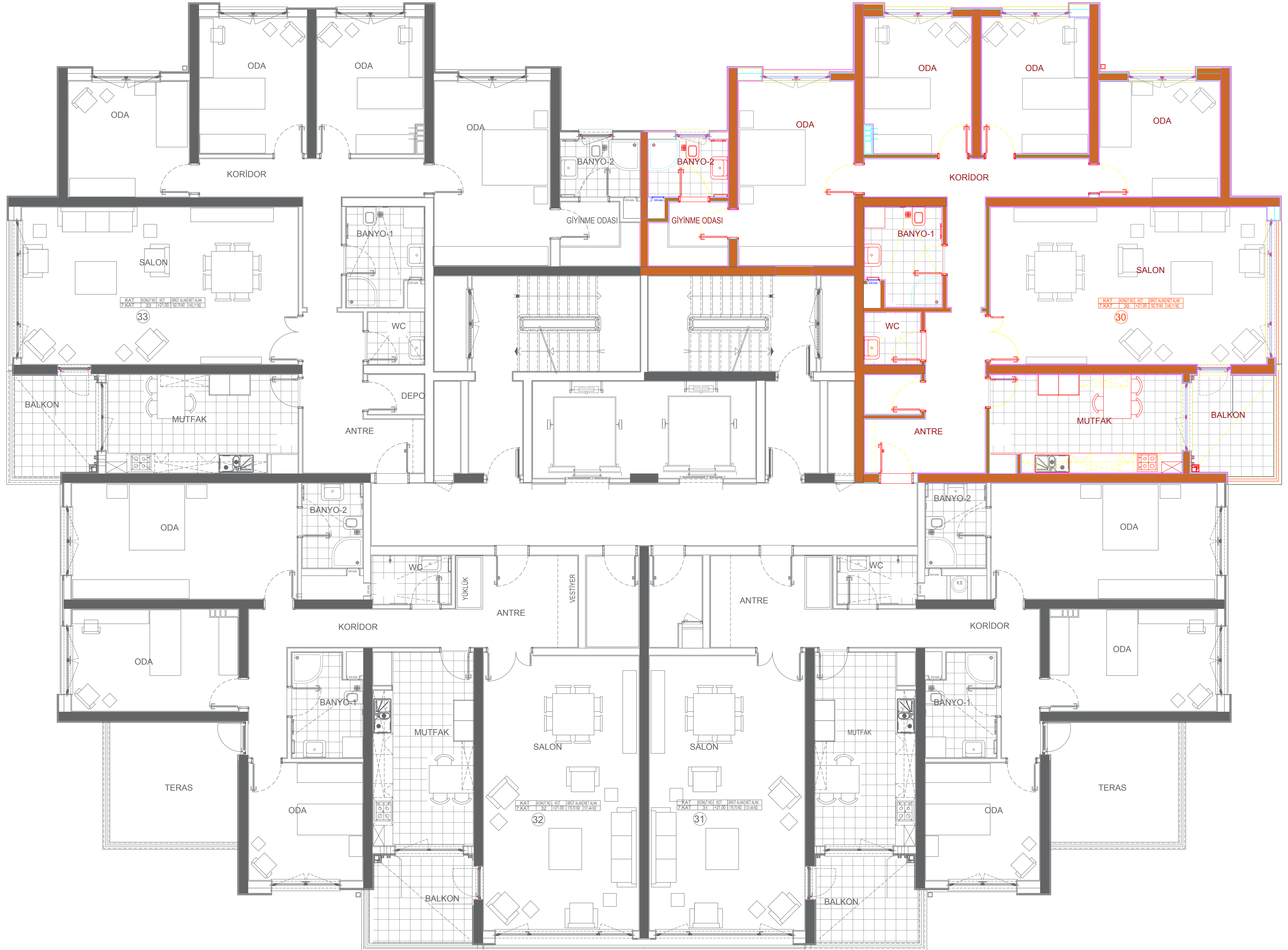
ANKARA SINCAN SARAYCIK MAHALLESİ G.Ö.B. KENTSEL DÖNÜŞÜM PROJESİ SA TİP BLOK 7. KAT 4+1 PLANI
